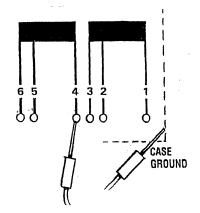
TEST EACH WINDING TO CASE GROUND
