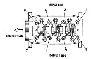
CYLINDER HEAD BOLTS TIGHTENING SEQUENCE
